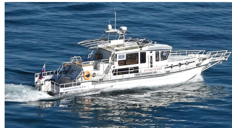
в эксплуатацию судно было введено с более легкими винтами G3, а максимальная скорость снижена до 60 км/ч. Облегчение винтов необходимо, поскольку нагрузка может меняться значительно, плюс нужен запас мощности для движения по волне и при сильном ветре.
